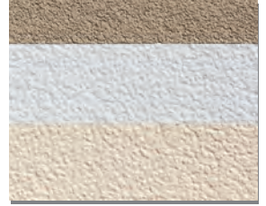
厚付け仕上げ
